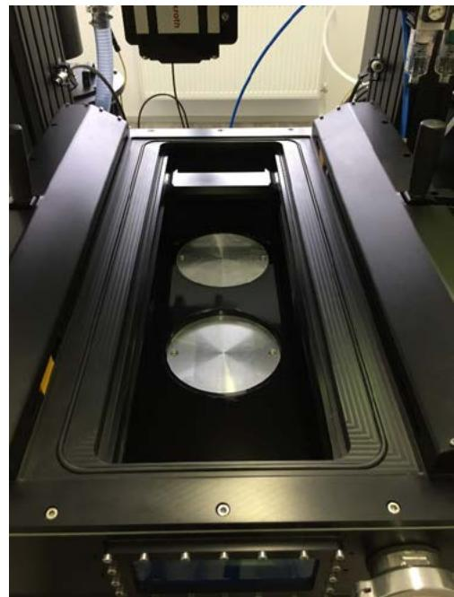
Laboratorijski 3D tiskalnik kovinskih materialov s selektivnim laserskim taljenjem (SLM) z možnostjo ogrevanja podlage.
