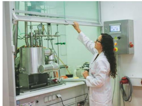
Laboratorijski mešalni reaktor za sintezo polimerov
